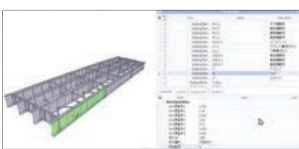
I/F C変換機能で部材ごとに属性情報を確認できる
